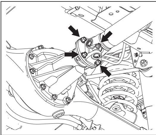
6. 将后桥传动轴总成的中间支撑与车架相对应的接口的联接螺栓与螺母紧固
